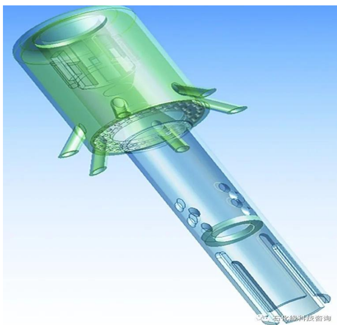
图 1 沸腾床气液分布器结构示意图
